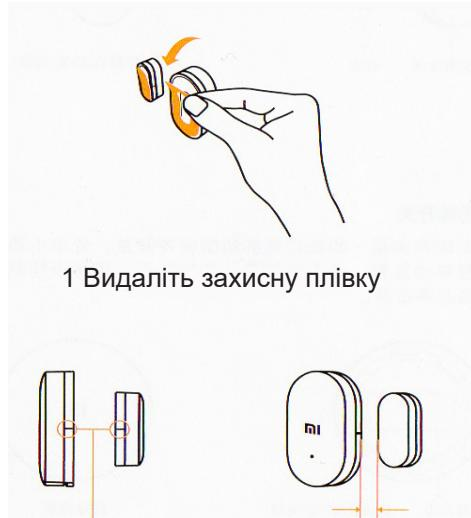
Під час встановлення, намагайтесь максимально вирівняти рівень розташування основного датчика і магніту за спеціальною позначкою.
