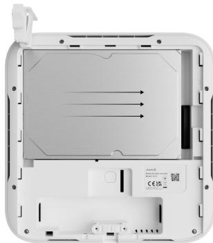
5. Опустіть фіксатор жорсткого диска.
