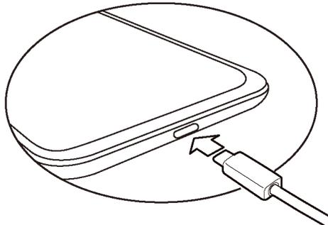
1. Переконайтеся, що кабель USB правильно встановлений, а потім підключіть кабель до мікро-порту USB телефону M882H, що знаходиться в його нижній частині;
