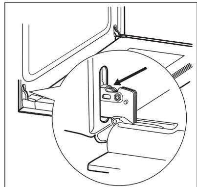
2. Поднимите и до конца поверните рычажки на обеих петлях.
