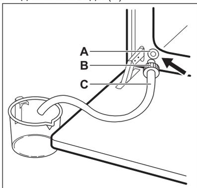
3. Откройте дверцу духового шкафа и вставьте штуцер (В) в клапан для слива воды (А).
