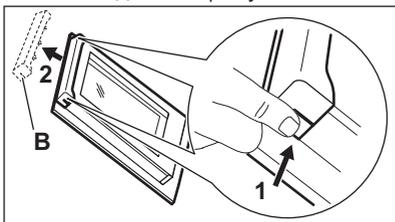
6. Чтобы снять дверную планку, потяните ее вперед.
