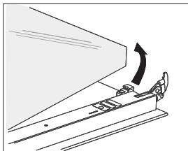
**2** Возмите стекло дверцы за нижний край, немного приподнимите, чтобы оно освободилось из фиксаторов, и снимите.
