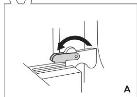
**2** **A** Откиньте фиксаторы до конца назад (при обычном закрывании дверцы).
