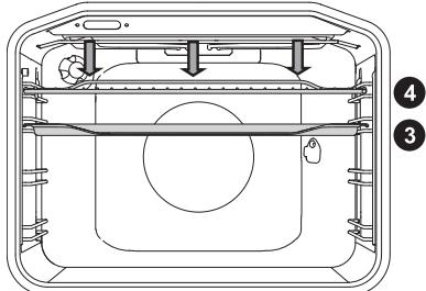
При **большом гриле** включаются верхний нагревательный элемент и инфранагреватель, расположенные под потолком духовки.
