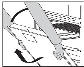
**3** Медленно закрывайте дверцу, пока фиксаторы не упрются в прорези на дверце. Немного приподнимите дверцу и извлеките из гнезд шарниров. Устанавливайте дверцу в обратном порядке. Если дверца не открывается / закрывается правильно, проверьте, правильно ли выемки на шарнирах сели в гнездах.
