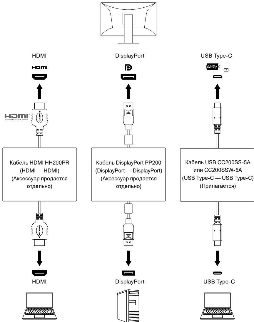
Если два ПК подключены к одному монитору, можно связать входные сигналы с портами USB для использования устройства USB, подключенного к монитору, с обоих ПК путем переключения между ними. Подробнее см. в разделе «[KVM](#)» (стр. 31).
