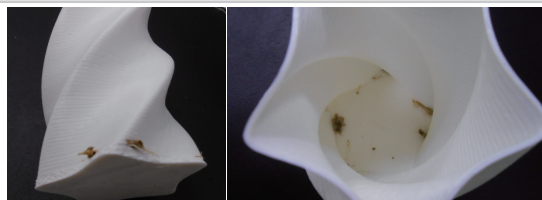
II. Объект печати загрязнен различным цветным пластиком
