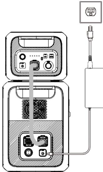
(Перезарядка AC200MAX за допомогою перехідника)
