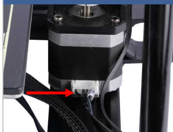
4. Левый электродвигатель оси Z
