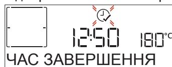
Натисніть + або —, щоб встановити бажаний час завершення готовування, потім натисніть ✓ для підтвердження і активуйте функцію. Покладіть продукти в духову шафу та зачиніть дверцята: Функція запуститься автоматично через обчислений період часу, щоб готовування завершилося в установлений час.
