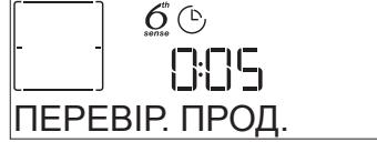
Пролунає звуковий сигнал і на дисплей буде відображене дію, яку потрібно виконати. Перевірте страву, зачиніть дверцята та продовжіть готовування.
