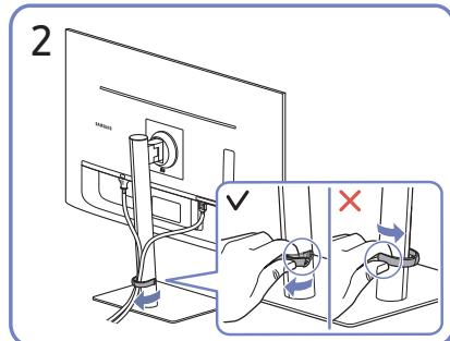
Потягніть за правий бік КРІПЛЕННЯ ДЛЯ КАБЕЛІВ НА ТРИМАЧІ ПІДСТАВКИ, щоб від'єднати від підставки. Якщо прикласти силу, можна пошкодити ліву сторону КРІПЛЕННЯ ДЛЯ КАБЕЛІВ НА ТРИМАЧІ ПІДСТАВКИ.
