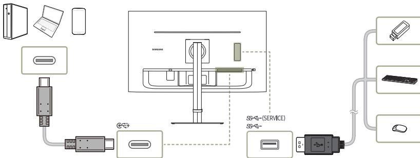
У разі використання виробу як концентратора до нього можна одночасно підключити різні пристрой-джерела та використовувати їх.
