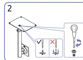
Поверніть гвинт для з'єднання внизу підставки до кінця так, щоб його було повністю зафіковано. Закрутіть великий гвинт посередині.
