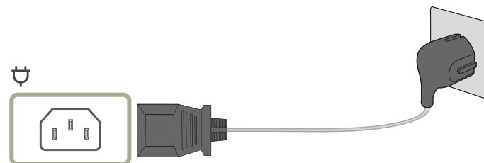
Щоб використовувати виріб, під'єднайте кабель живлення до розетки електромережі та роз'єму на виробі.
