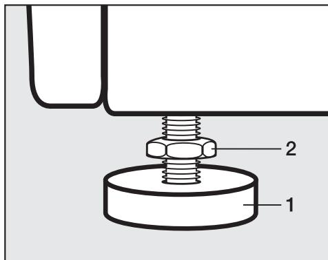
■ За годинниковою стрілкою відгинчуйте контргайку **2** за допомогою гайкового ключа, що додається. Викрутіть контргайку **2** разом з ніжкою **1**.
