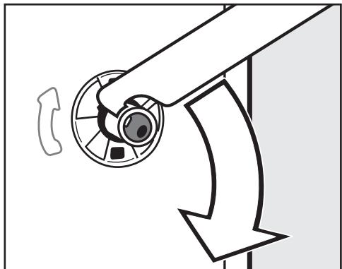
■ Поверніть лівий транспортувальний стрижень гайковим ключем, що додається, на  $90^\circ$  та
