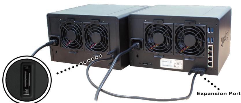
После подключения DX517 будет включаться и отключаться автоматически при включении или отключении DiskStation.
