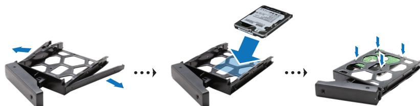
4 Вставьте лоток с установленным диском в пустой отсек для дисков.
