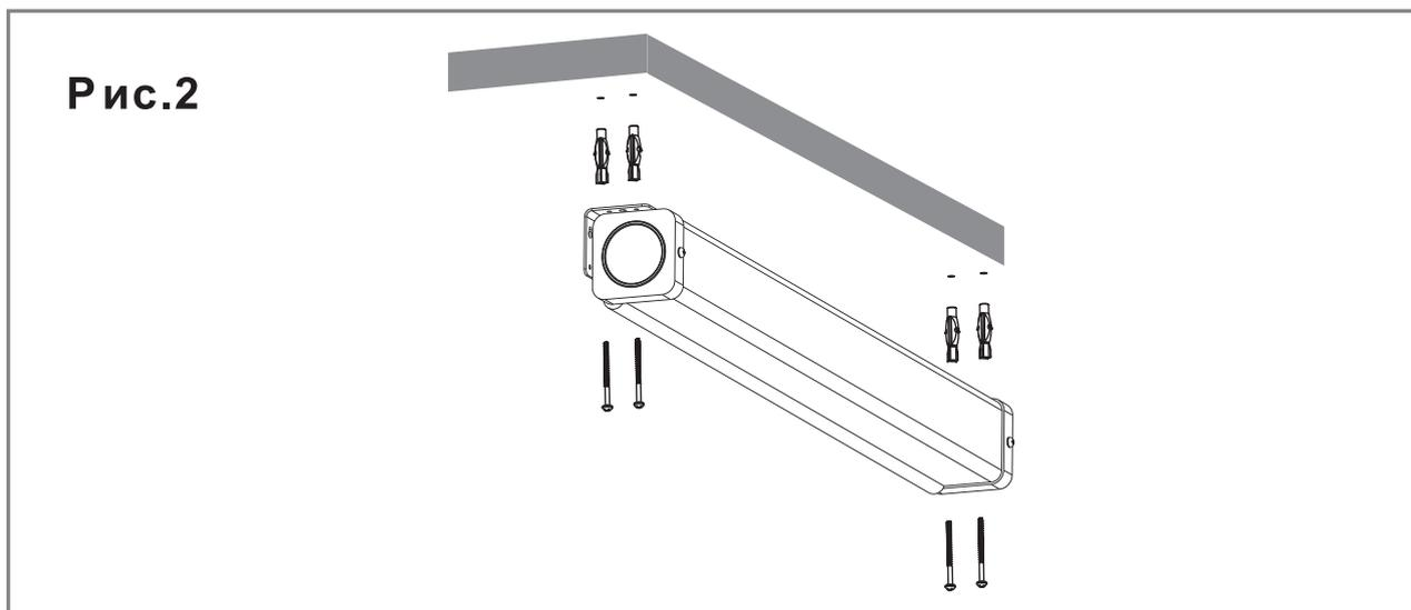
**Настінний монтаж варіант:** Відзначте 4 монтажних отвори на стіні і просвердлите 4 отвори. Потім вставте гвинти з 4 порожнистими якорями, як показано на рис.1, і затягніть усі гвинти.
