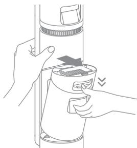
2. Извлеките фильтр из крышки бака с отработанной водой. Снимите крышку бака и вылейте отработанную воду.
