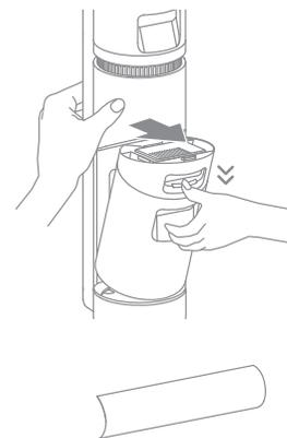
2. Вийміть фільтр з кришки резервуара для брудної води. Зніміть кришку резервуара та вилийте брудну воду.
