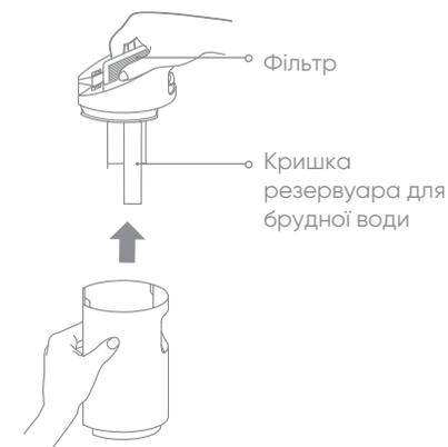
3. Промийте резервуар для брудної води та кришку резервуара чистою водою. Очистіть резервуар щіткою для чищення, що входить у комплект.
