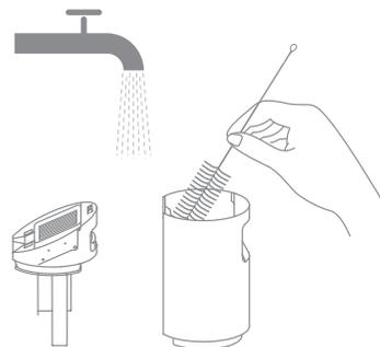
4. Знову встановіть фільтр і кришку резервуара для брудної води. Потім знову встановіть резервуар для брудної води, доки не почуєте клацання.
