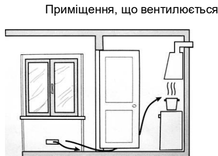
Збільшення вентиляційного отвору між вікном і підлогою
