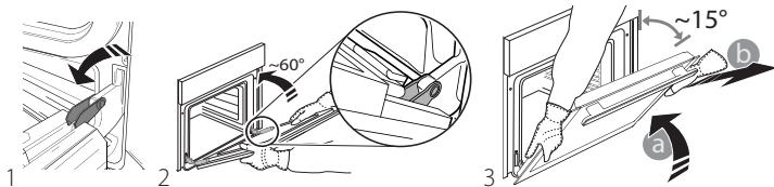
Положите дверцу на мягкую поверхность. Для установки дверцы поднесите ее к духовке, совместите крюки петель с гнездами и вставьте верхние части петель в гнезда. Опустите дверцу, а затем полностью откройте ее. Поверните фиксаторы в исходное положение: вниз до упора. Закройте дверцу и убедитесь, что она находится в одной плоскости с панелью управления. Если нет, повторите приведенные выше шаги.
