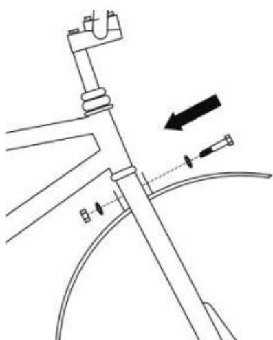
1. Помістіть переднє крило в положення, показане на малюнку зліва, вставить гвинт, додати шайби і затягніть гайки, як показано на малюнку.
