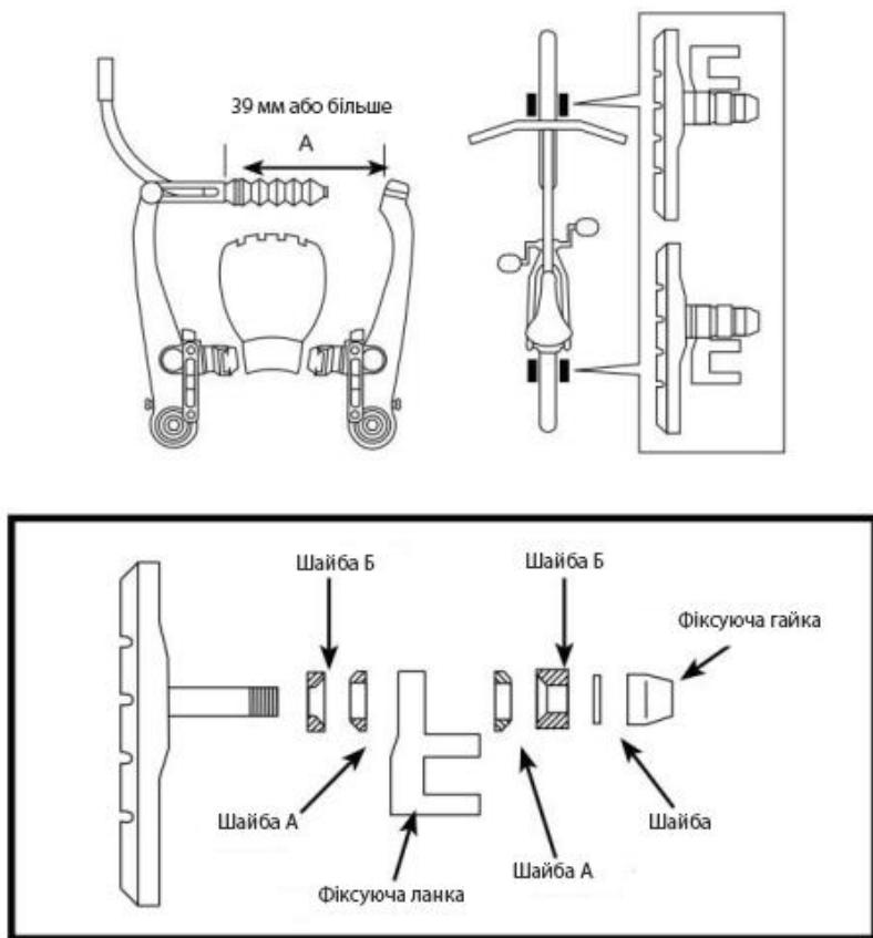
3. Налаштуйте гальмівну колодку, щоб нічого не терлось. Після цього затягніть гайку.
