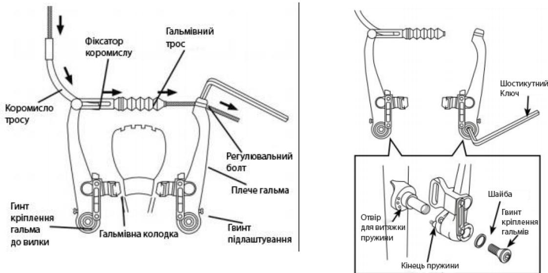
1. Якщо встановлено гальмо (V-Brake), вставте плече гальма у центральний отвір пружини на вилці для монтажу гальма, а потім прикріпіть плече за допомогою гвинта кріплення.
