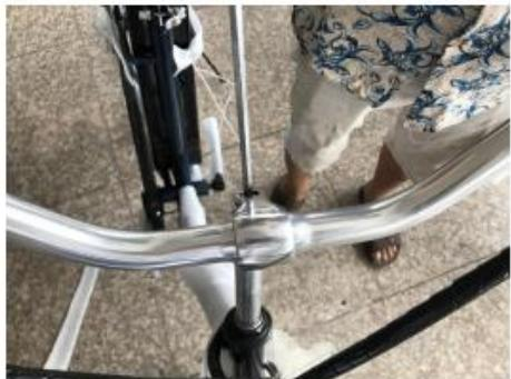
3. Затягніть шток болта, дотримуючись мінімальної позначки. Перевірте щоб кермо та колесо дивились в одну сторону та були рівними, як показано на малюнку. Перевірте рульову систему на вільний хід та наявність люфтів.
