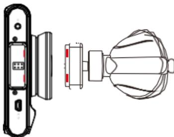
Основа тримача, яка має з одного боку **2** пази, повинна бути з'єднана з **2** затискачами на корпусі
