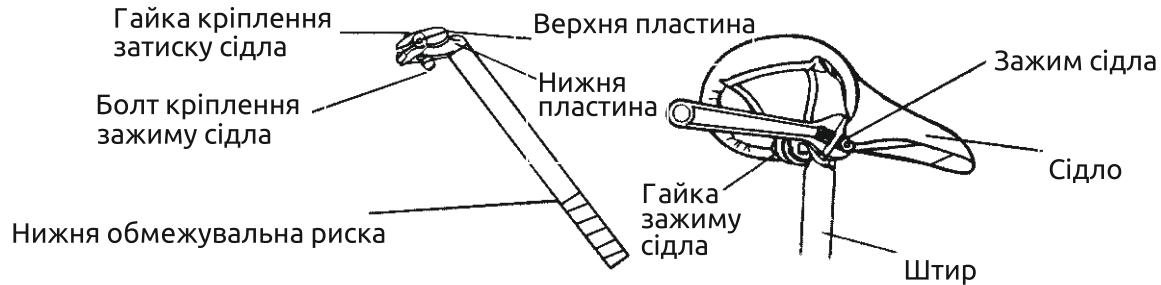
2. В залежності від типу використовуваного на вашому електровелосипеді підсідельного штиря на затиску сідла можуть використовуватися болт або гайка. Перевірте, щоб вони були надійно затягнуті.
