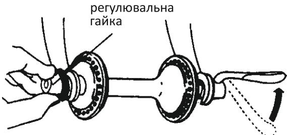
3. Встановіть важіль ексцентрикового затиску в положення ЗАКРИТО. Важіль в цьому положенні повинен бути спрямований до задньої частини електровелосипеда і проходити вздовж рами електровелосипеда. Переконайтесь в тому, що важіль повністю повернуто у положення ЗАКРИТО. Момент затиску 50 - 75 кгс \* см
