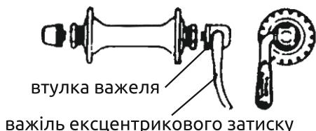
Зусилля притиску регулюється за допомогою регулювальної гайки. При обертанні гайки за годинниковою стрілкою, зусилля притиску зростає, а при обертанні гайки проти годинникової стрілки – зменшується.
