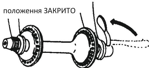
**ПОПЕРЕДЖЕННЯ:** якщо важіль ексцентрикового затиску легко ставиться в положення ЗАКРИТО, то це означає, що зусилля притиску недостатнє. Поверніть важіль ексцентрикового затиску в положення, при якому він перпендикулярний до рами, і знову повертайте регулювальну гайку рукою за годинниковою стрілкою до упору. Потім назад поставте важіль в положення ЗАКРИТО
