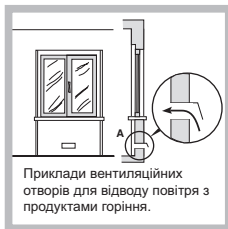
Сусіднє приміщення має вентилуватися. Збільшений вентиляційний отвір між вікном і підлогою
