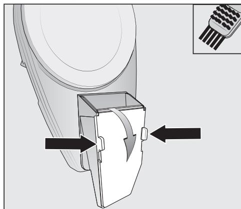
■ Натисніть на обидва фіксатори на фільтрі попереднього очищення та вийміть фільтр.
