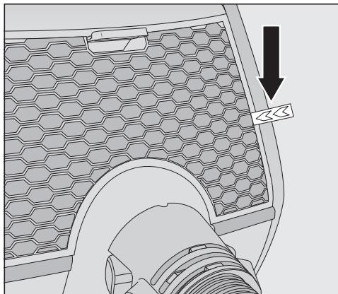
Обладнання з фільтром вихідного повітря HEPA AirClean можна розпізнати за вказівною стрічкою, що вистуває збоку відсіку фільтра вихідного повітря.
