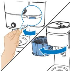
**2** Öffnen Sie den Filterhalter, um Zugang zur Trichterschütte zu erhalten.
