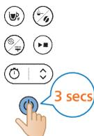
**15** Aby wyłączyć urządzenie, naciśnij i przytrzymaj przycisk uruchomienia/wstrzymania przez 3 sekundy.
