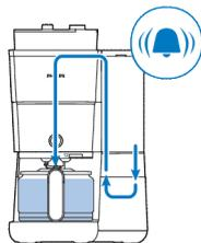
**12** Vent til maskinen er ferdig med å trakte avkalkingsblandingen.
