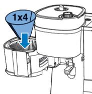
11 Laita suodatinpaperi (kokoa 1x4 tai nro 4) suodatinkoriin.
