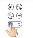
3 Zodra het uur is ingesteld, drukt u op de timerknop om het uur te bevestigen.
