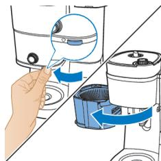
**5** Posizionare un filtro di carta (tipo 1x4 o n. 4) nel cestello del filtro e chiudere il supporto del cestello.
