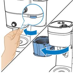
5 Kağıt filtreyi (tip 1x4 veya no. 4) filtre sepetine yerleştirin ve filtre sepeti tutucusunu kapatın.
