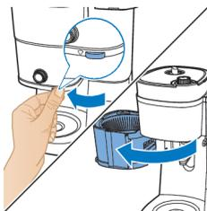
**10** Ta tag i fliken för att öppna filterhållaren.
