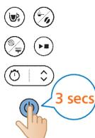
**22** Aby wyłączyć urządzenie, naciśnij i przytrzymaj przycisk uruchomienia/wstrzymania przez 3 sekundy.
