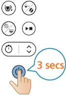
**15** Para desligar o aparelho, prima continuamente o botão iniciar/interromper durante três segundos.
