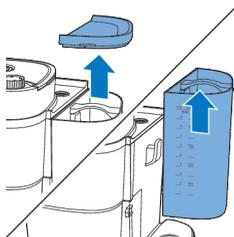
**2** Umple rezervorul cu apă de la robinet.
