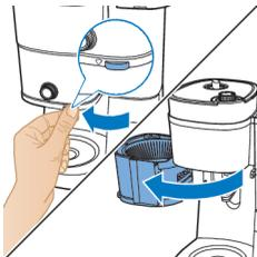
**3** Setzen Sie einen Papierfilter (Typ 1x4 bzw. Nr. 4) in den Filterkorb ein.
