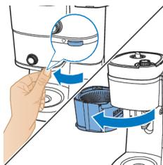
**5** Placez un filtre en papier (type 1 x 4 ou n° 4) dans le porte-filtre et fermez le support pour porte-filtre.
