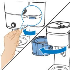
**24** Αφαιρέστε το χρησιμοποιημένο χαρτινό φίλτρο.
