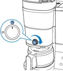
5 Drehen Sie den mittleren Drehregler auf die Kanneneinstellung.
