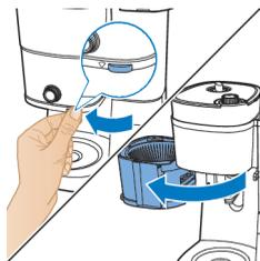
5 Legg i et papirfilter (type 1x4 eller nr. 4) i filterkurven og lukk filterkurvholderen.
